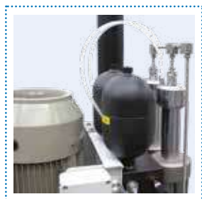
Accumulateur à membrane d'azote pour la gestion de circuit de retour des cylindres hydrauliques
