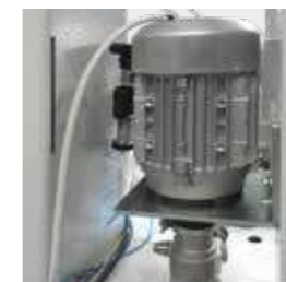
Autoclave di alimentazione acqua integrato (std) Integrated boost water supplier (std)
