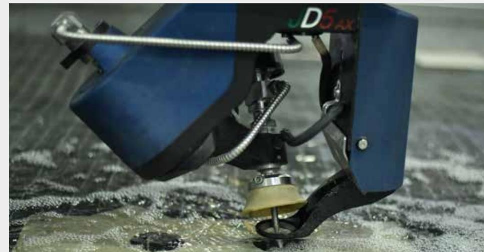
Testa di taglio a 5 assi con tecnologia JDC - Jet Drive Compensation - Efficace movimentazione della testa per realizzare dei tagli inclinati e controllare la conicità del solco di taglio (Opt)
