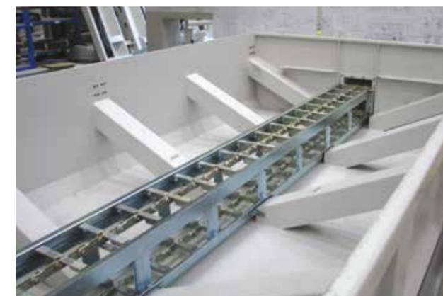
Sistema dragante "no maintenance" per la rimozione automatica dell'abrasivo esausto. Il sistema di evacuazione abrasivo, all'interno della vasca, è protetto sia da cestelli per la raccolta degli sfridi di lavorazione che da una gabbia metallica. La vasca è sempre predisposta per poter installare in un secondo momento tutto il gruppo draga. (opt)
